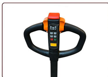
POIGNÉE INTELLIGENTE Code PIN pour un démarrage sécurisé
