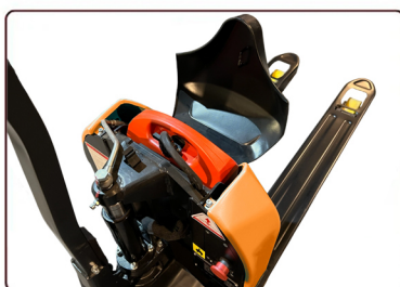
BATTERIE LITHIUM 48V batterie lithium sans entretien
